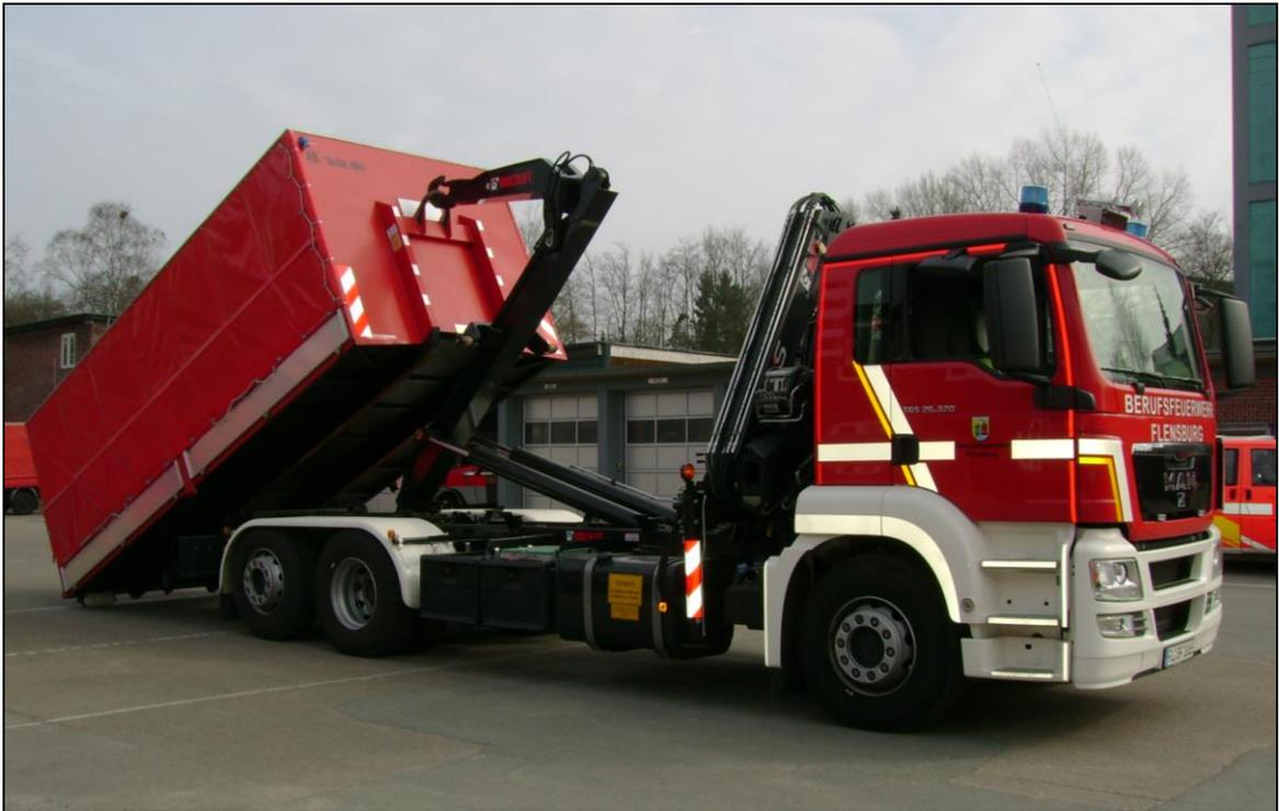
Abb. 123: Wechselladerfahrzeug mit Abrollbehälter Technische Hilfeleistung. (Foto: Carsten Herzog)
